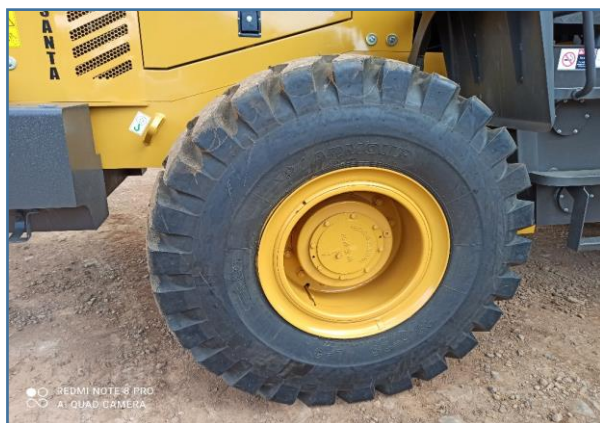
Pneus novos 23.5-25 com no mínimo 20 lonas e desenho E3/L3 que vieram junto a máquina
