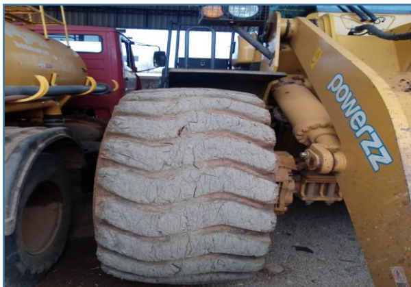
Pneus dianteiros da máquina, sinais visíveis de desgaste e necessidade de recondicionamento
