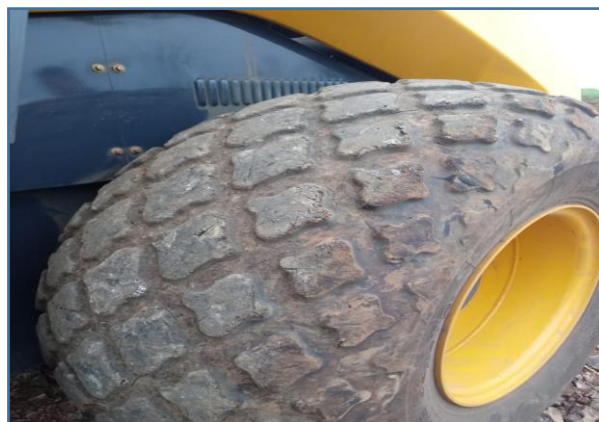
Pneu da máquina, sinal visível de desgaste e necessidade de recondicionamento
