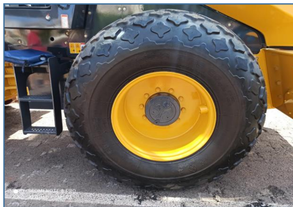
Imagem do pneu novo 23.1-26 flutuações de 08 lonas que veio junto a máquina
