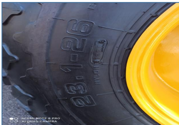
Imagem com detalhe do tamanho do pneu novo 23.1-26 flutuações de 08 lonas que veio junto a máquina
