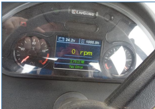
Horímetro atual da máquina, em 01/09/2023 a mesma está com 1.000,9 horas
