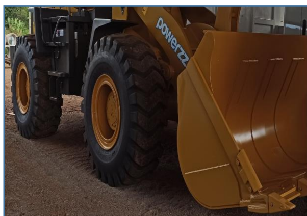
Imagens com outros ângulos dos pneus novos 23.5-25 com no mínimo 20 lonas e desenho E3/L3 que vieram junto a máquina
