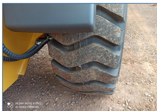
Pneus novos 23.5-25 com no mínimo 20 lonas e desenho E3/L3 que vieram junto a máquina
