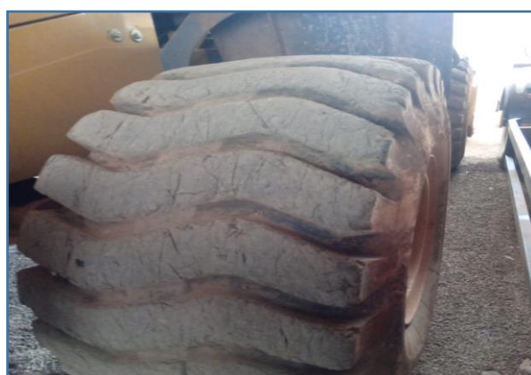
Pneus traseiro da máquina, sinais visíveis de desgaste e necessidade de acondicionamento
