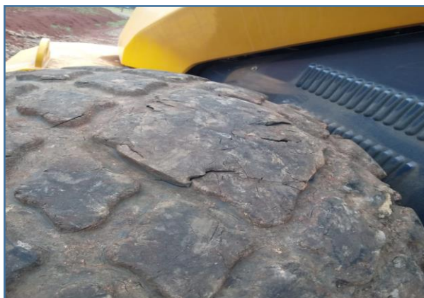
Imagens com detalhes do pneu extremamente danificado
