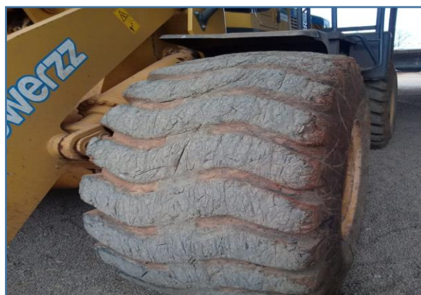
Pneus dianteiros da máquina, sinais visíveis de desgaste e necessidade de recondicionamento
