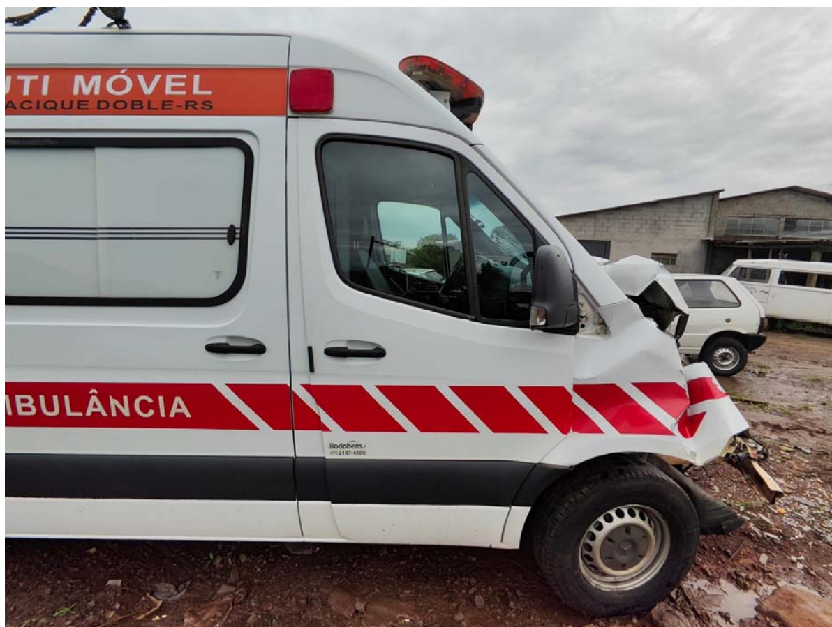
Imagem 2 – Foto lateral direita (avarias no para lama dianteiro e um desalinhamento da porta).
