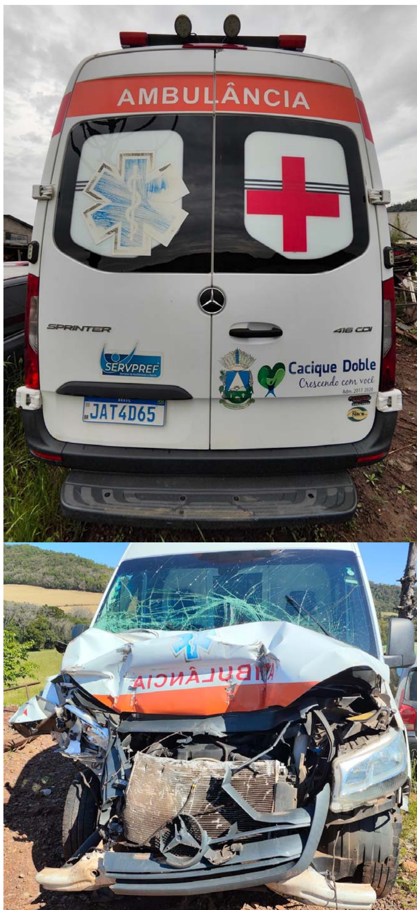
Imagem 4 – Foto dianteira e traseira, permitindo observar os danos no conjunto ótico, para-choque, capô, para-brisa, grade frontal, radiador, hélice e diversos outros itens da parte mecânica.
