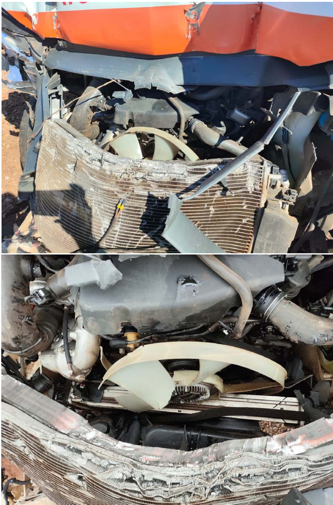
Imagem 7 – Fotos do cofre do motor, permitindo observar danos no radiador, intercooler, grade frontal, hélice e diversos outros itens da parte mecânica.
