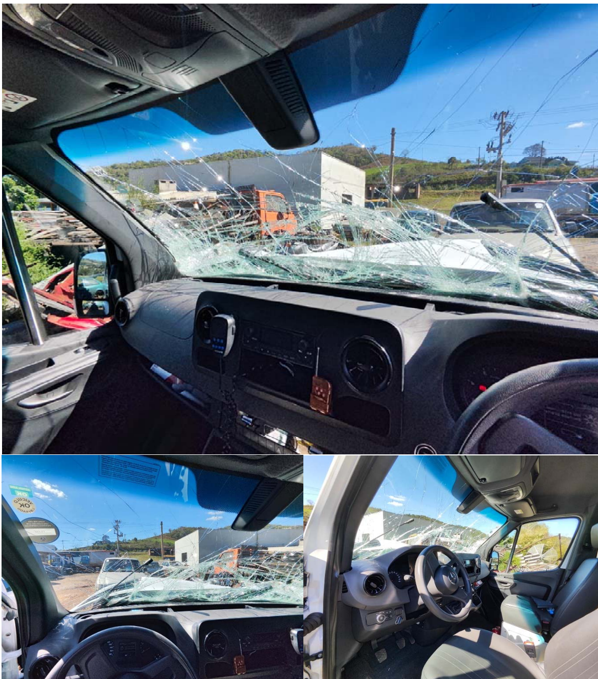
Imagem 9 – Fotos do interior da cabine, apresentando danos visíveis no para-brisa.
