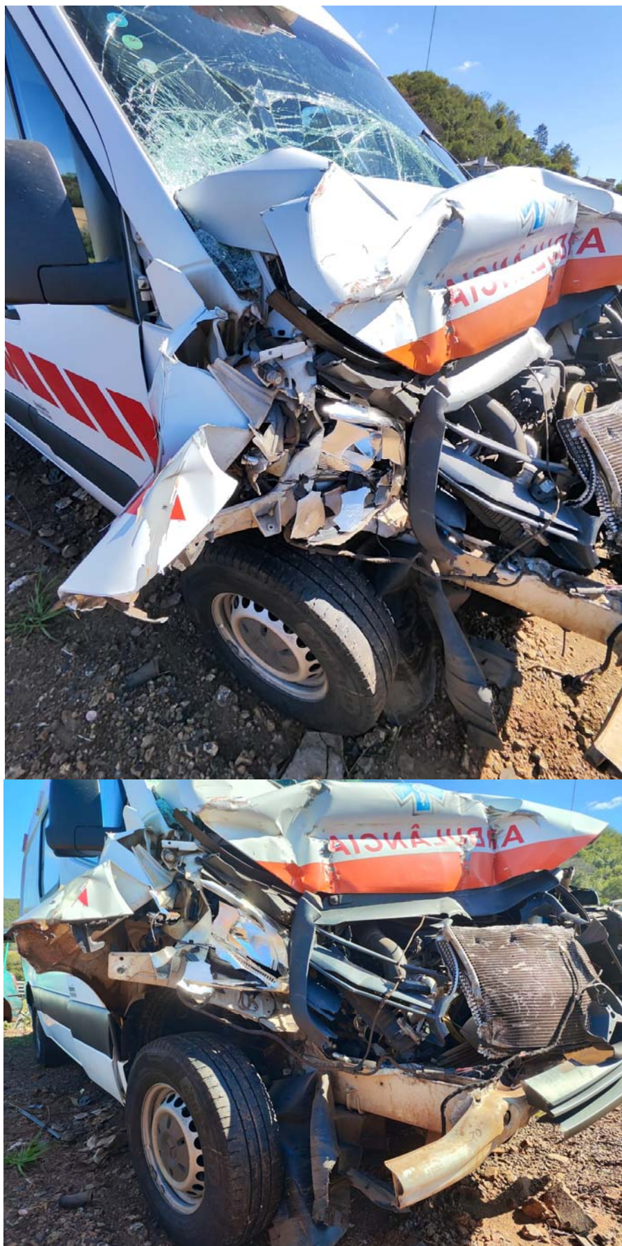
Imagem 6 – Foto do ângulo frontal direito, permitindo observar os danos no conjunto ótico (farol direito), para-choque, capô, para-lama, para brisa e diversos itens da parte mecânica.
