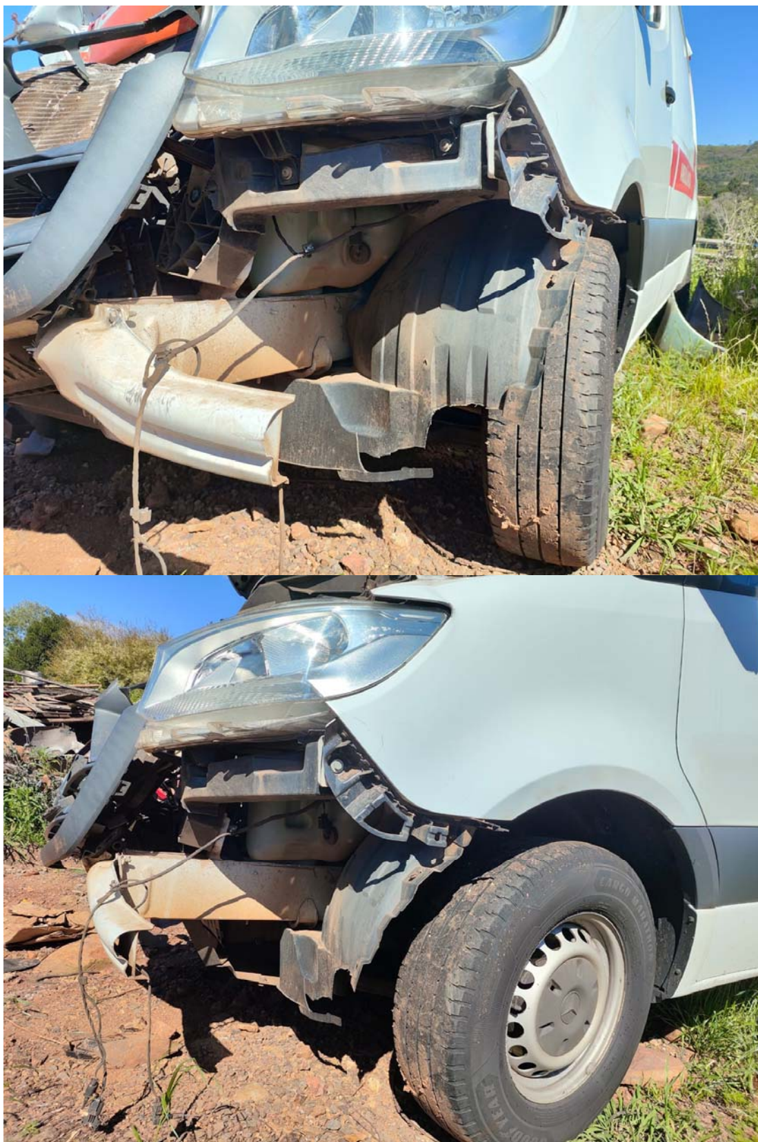
Imagem 5 – Foto do ângulo frontal esquerdo inferior, permitindo observar os danos no conjunto ótico (farol esquerdo), para-choque, protetor interno do para-lama, chicote, etc.
