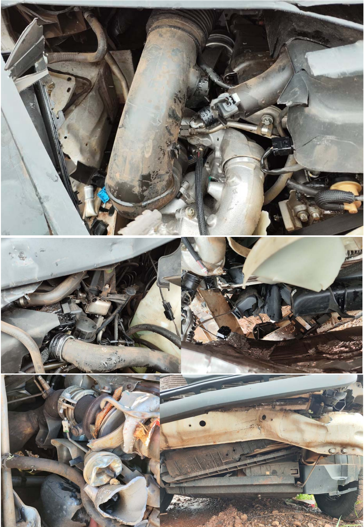
Imagem 8 - Fotos do cofre do motor, permitindo observar danos no turbocompressor, intercooler, grade frontal, travessa do para-choque e diversos outros itens da parte mecânica.
