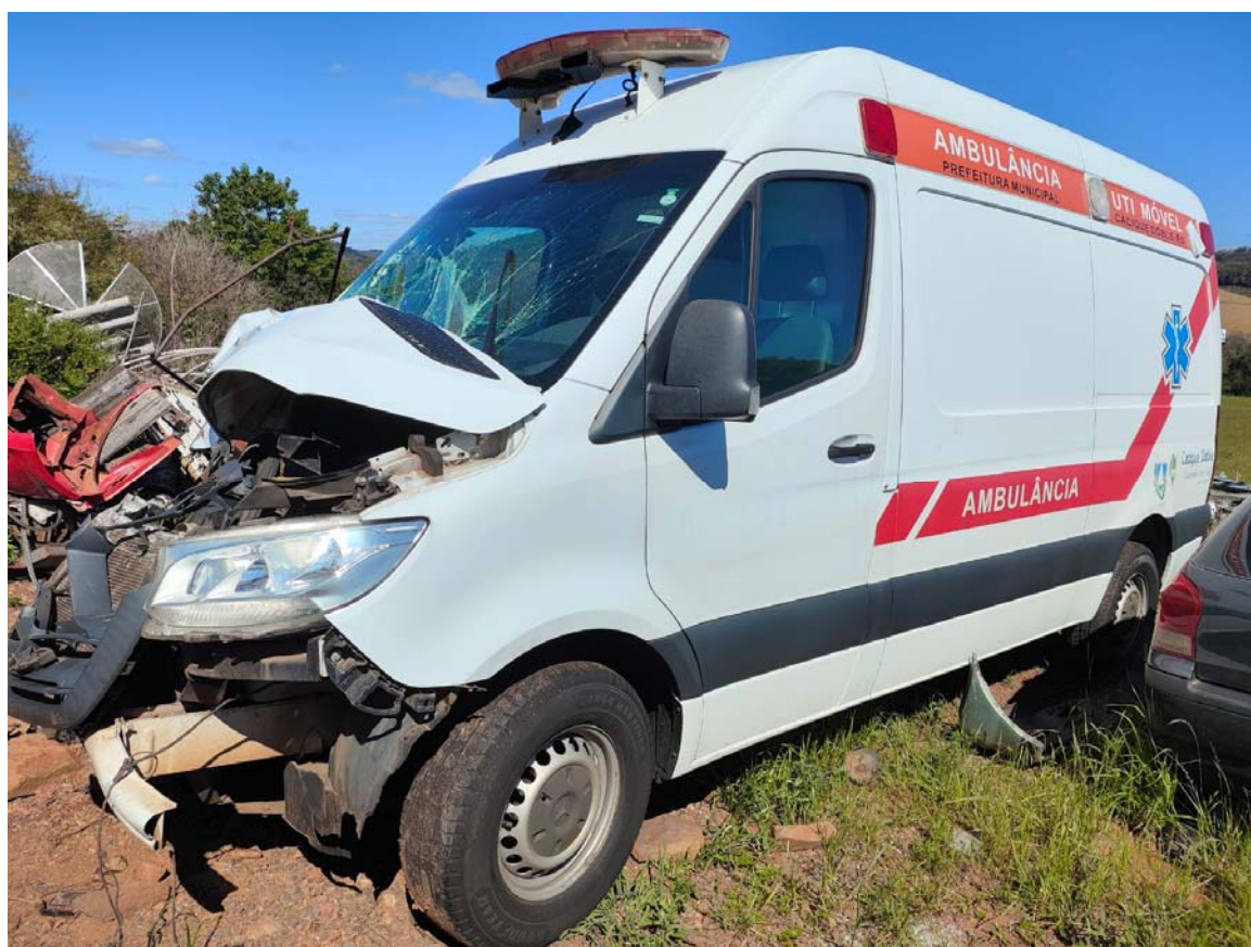
Imagem 3 - Foto do ângulo frontal esquerdo, permitindo observar os danos no conjunto ótico (farol esquerdo), para-choque e capô, para brisa, etc.
