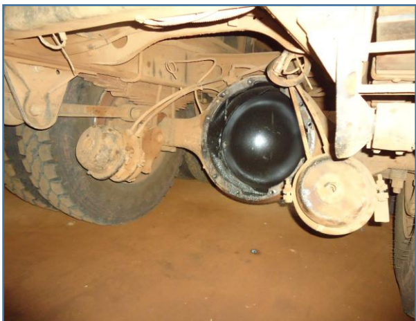
IMAGEM INFERIOR DO EQUIPAMENTO COM CONJUNTO DIFERENCIAL E EIXO CARDÃ DESMONTADOS
