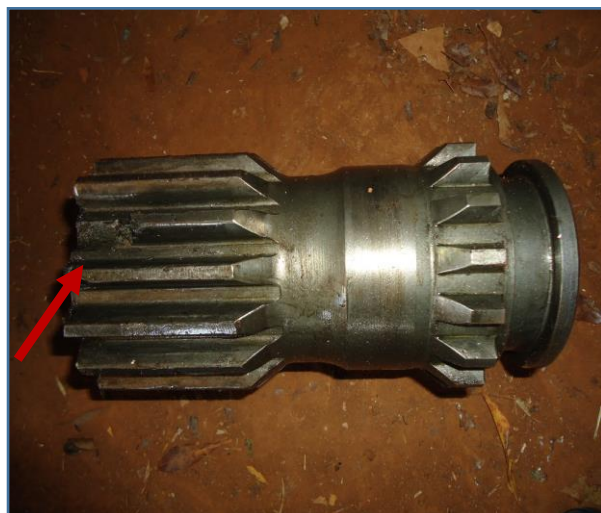
DETALHE LUVA REDUZIDA DANIFICADA
