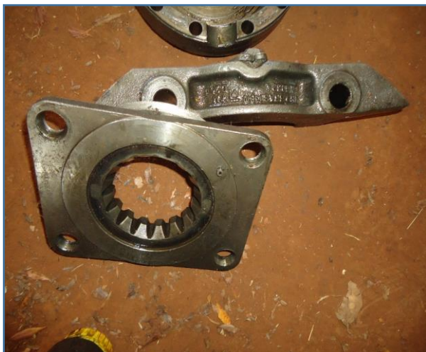
PLACA DE TRAVAMENTO DANIFICADA
