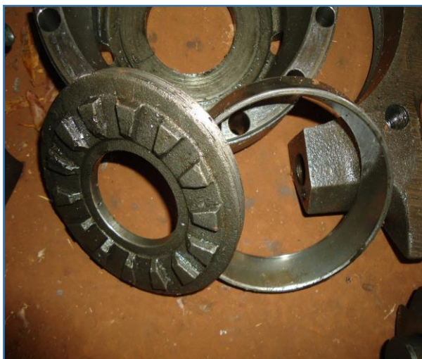
INTERNOS DO CONJUNTO DIFERENCIAL DANIFICADOS
