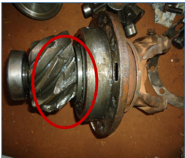
DETALHE PINHÃO DANIFICADO
