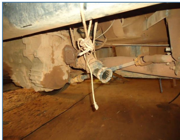
IMAGEM INFERIOR DO EQUIPAMENTO COM CONJUNTO DIFERENCIAL E EIXO CARDÃ DESMONTADOS
