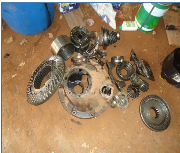
INTERNOS DO CONJUNTO DIFERENCIAL DESMONTADOS
