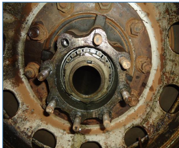
ROLAMENTOS INTERNOS E EXTERNOS DOS CUBOS DE RODAS TRASEIROS DEVEM SER SUBSTITUÍDOS
