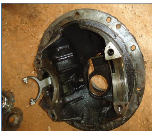
UMA DAS ROSCAS DA CARÇA DO CONJUNTO DIFERENCIAL ESTÁ DANIFICADA
