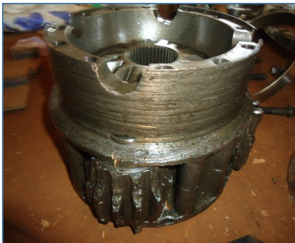
CAIXA SATÉLITE DANIFICADA
