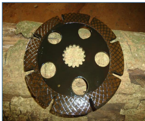
PLACAS E DISCOS DE FREIO DIANTEIROS E TRASEIROS ESTÃO BEM DANIFICADOS
