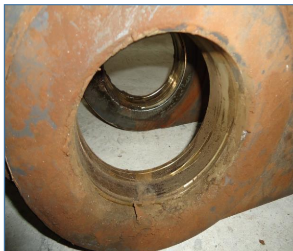
BUCHAS DE BRONZE DAS ARTICULAÇÕES TRASEIRAS DANIFICADAS
