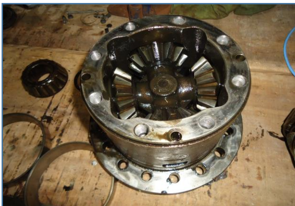
INTERNOS DO CONJUNTO DIFERENCIAL ESTÃO DANIFICADOS
