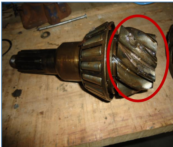
DETALHE PINHÃO DANIFICADO
