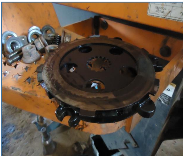
PLACAS E DISCOS DE FREIO DIANTEIROS E TRASEIROS ESTÃO BEM DANIFICADOS
