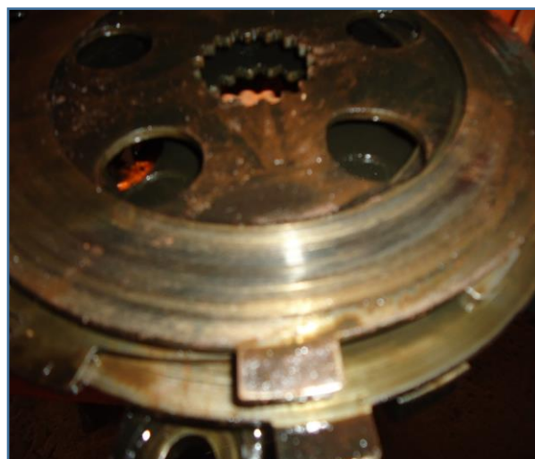
PLACAS E DISCOS DE FREIO DIANTEIROS E TRASEIROS ESTÃO BEM DANIFICADOS
