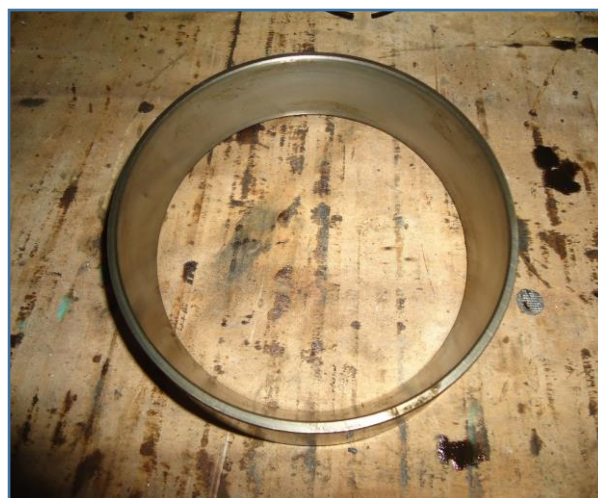
CAPA DE ROLAMENTO DANIFICADO
