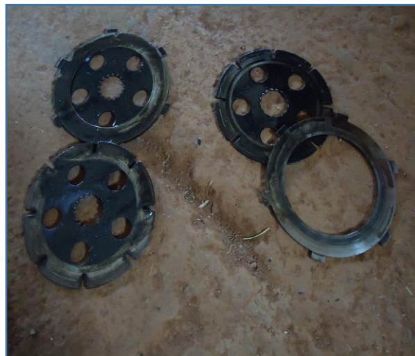
PLACAS E DISCOS DE FREIO DIANTEIROS E TRASEIROS ESTÃO BEM DANIFICADOS
