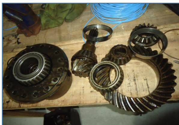
DIVERSOS ITENS DESMONTADOS DO CONJUNTO DIFERENCIAL DANIFICADO
