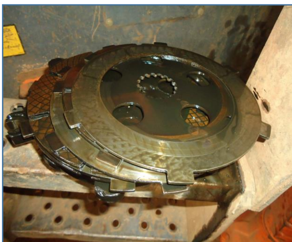
PLACAS E DISCOS DE FREIO DIANTEIROS E TRASEIROS ESTÃO BEM DANIFICADOS
