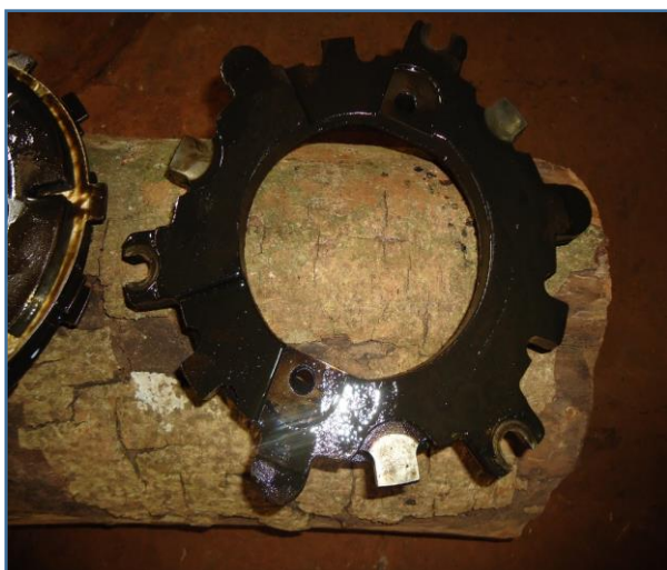
PLACAS E DISCOS DE FREIO DIANTEIROS E TRASEIROS ESTÃO BEM DANIFICADOS
