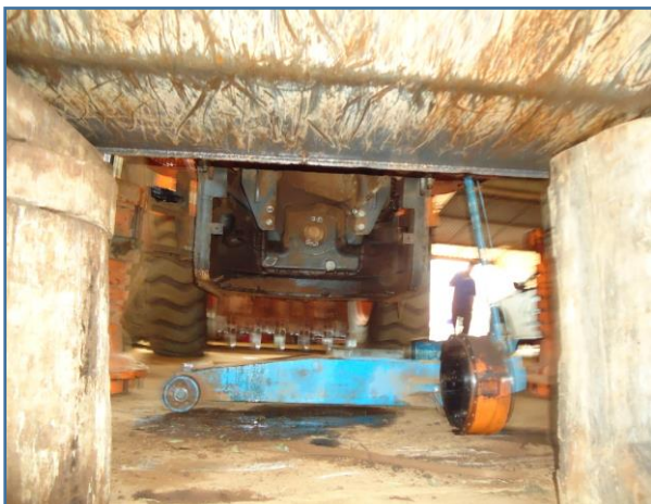
IMAGEM INFERIOR DO EQUIPAMENTO COM CONJUNTO DIFERENCIAL E EIXO TRASEIRO DESMONTADO
